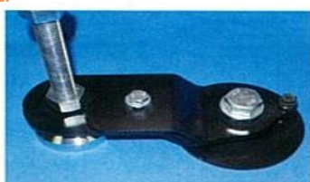
レベルアジャスター付きの機器を床に固定
